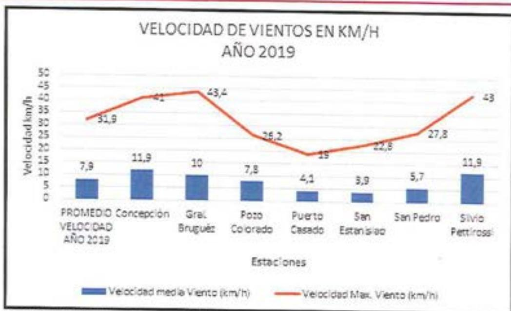
Figura 5.18: Velocidad de vientos en km/h - Año 2019, medida en las estaciones correspondientes a la zona de estudio.
