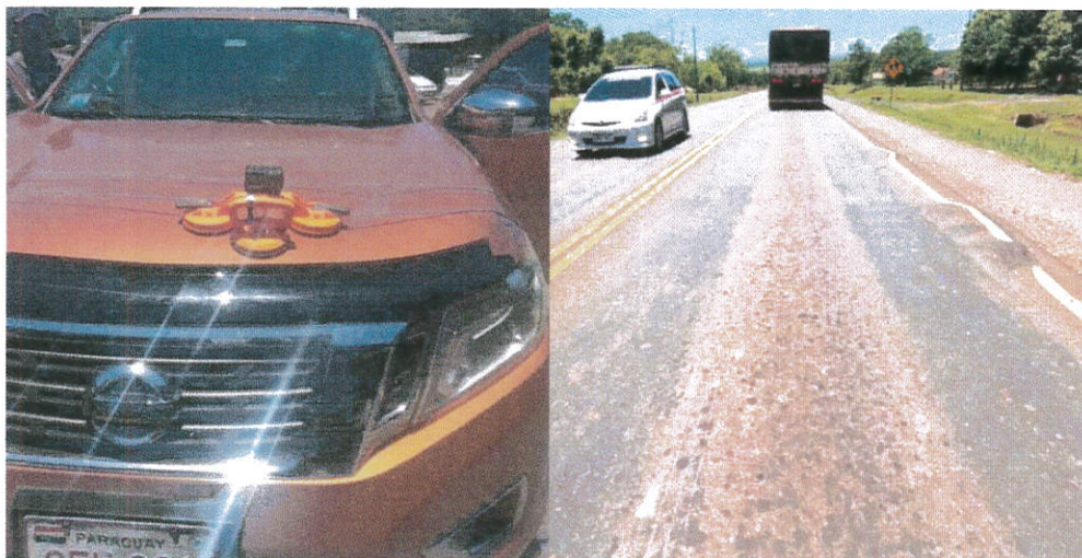
Sistema montado para registro fílmico continuo de la calzada.
