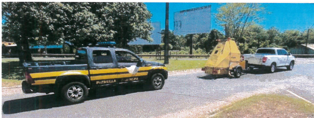
Ilustración 3-2 Medición de deflexiones con FWD
