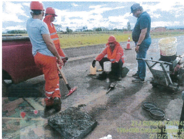
Km 196 - Carril descendente - Determinación de densidad natural
